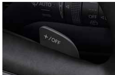
Schakelpeddel achter het stuurwiel voor instelling regeneratief remmen
